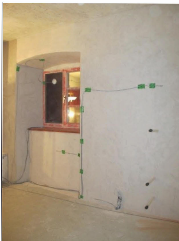
Figura 59: Senzori aplicați pe tencuială
