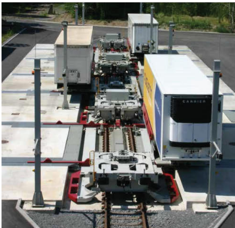
Figura 12: Foto: Sistemul Cargo-Beamer din Koeln 21
